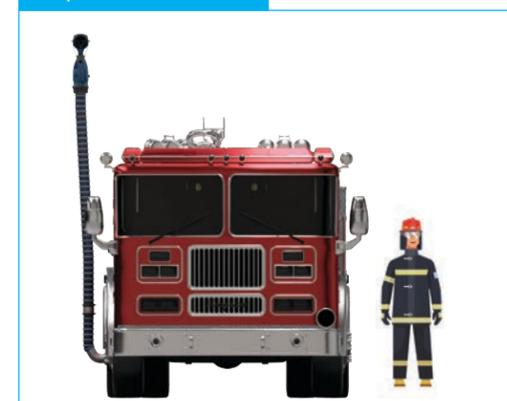
La capture à la source capture de manière proactive les gaz d'échappement du tuyau d'échappement et les élimine du bâtiment, éliminant ainsi toute exposition aux pompiers.
